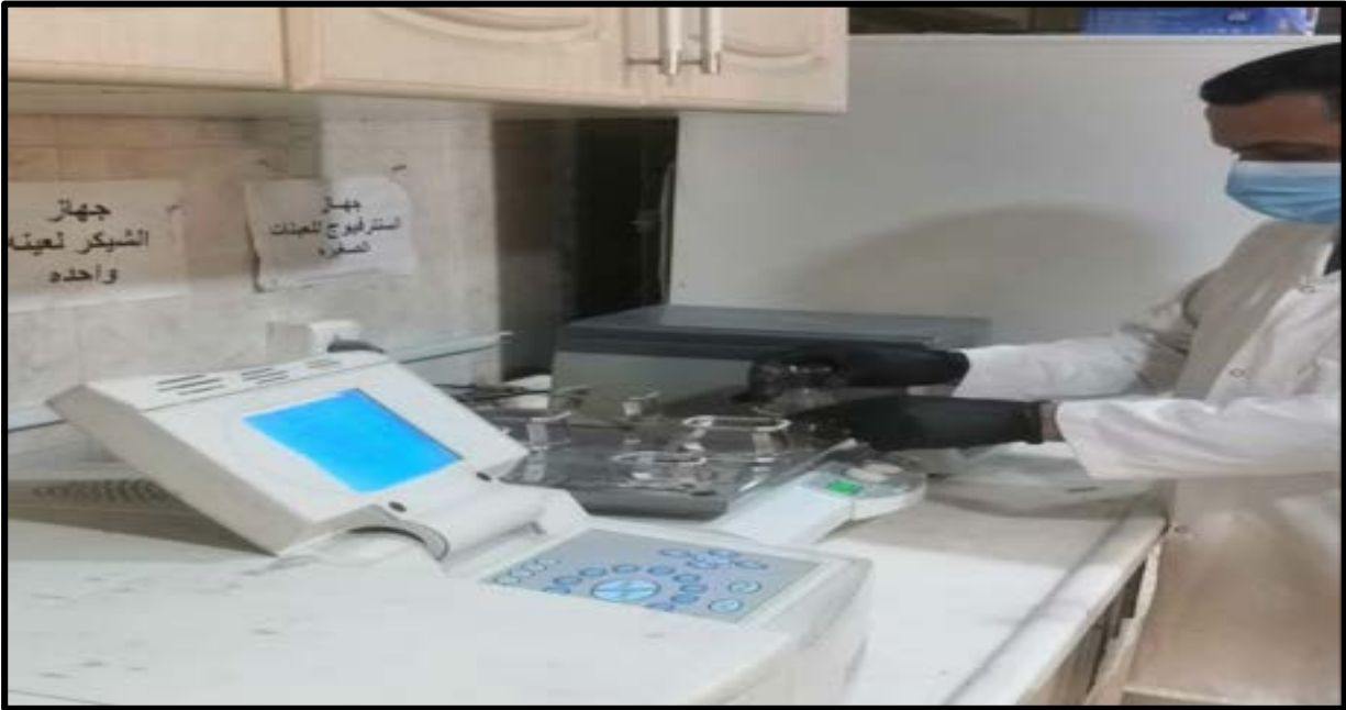
صورة (11) توضح عمل جهاز الشيكرا اثناء رج العينات
