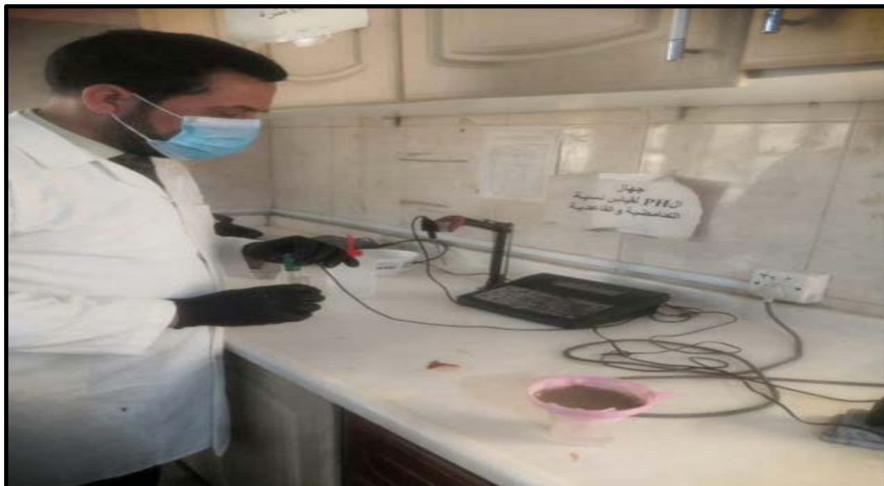
صورة (13) عملية قياس PH
