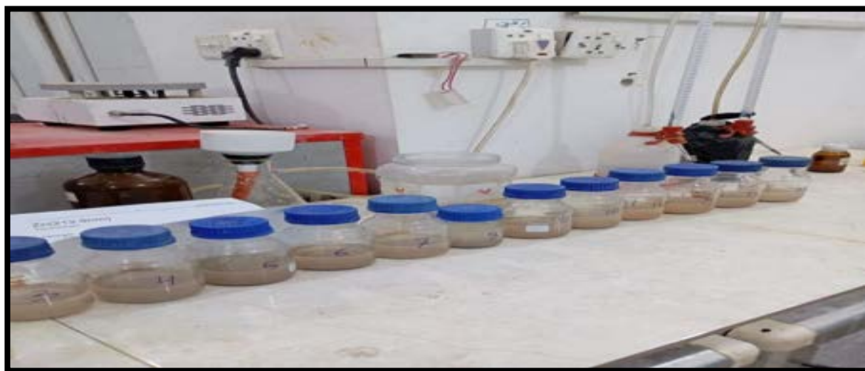
صورة (10) إضافة محلول الماء المقطر للعينات وتركها لمدة 15 دقيقة
