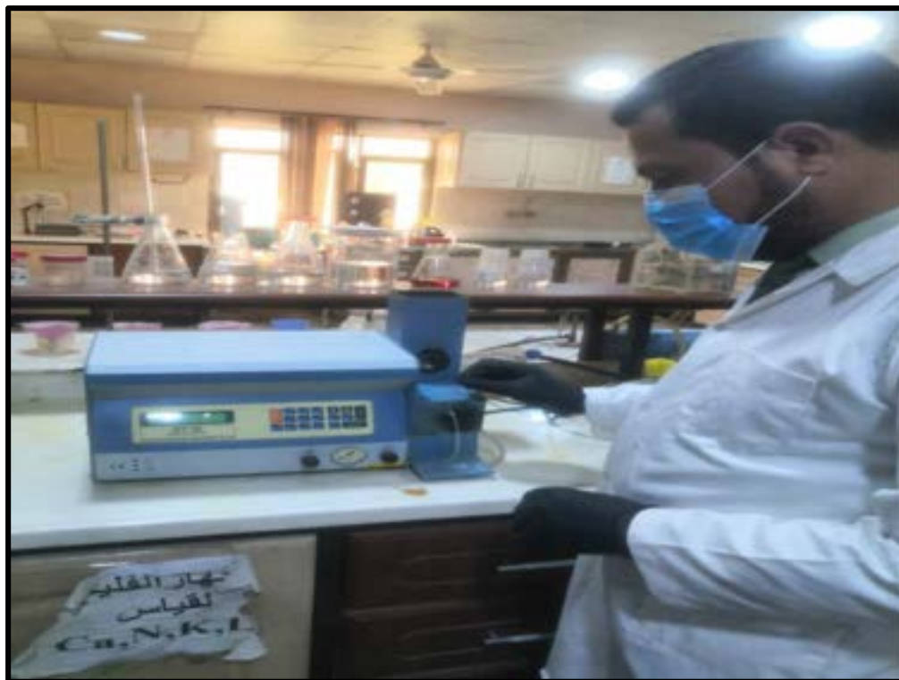
صورة (15) جهاز الفليم لقياس Na. Ca. K. L
