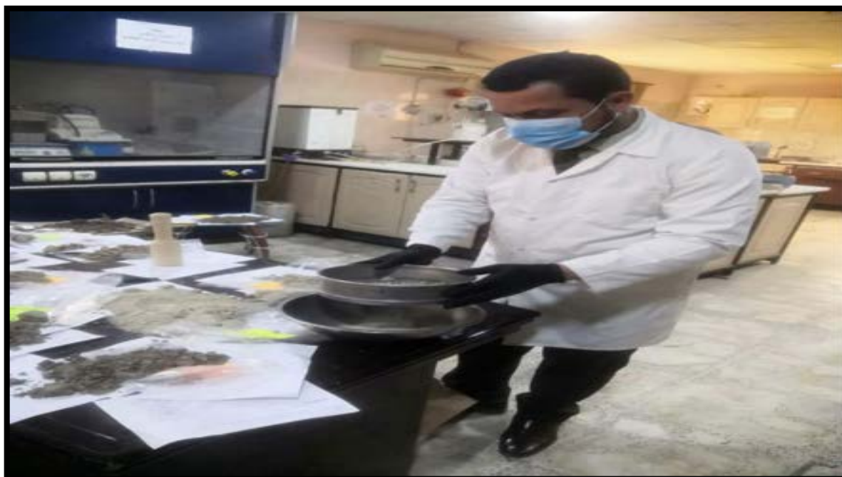
صورة (8) عملية نخل العينة بمنخل قطر الفتحات 2ملم
