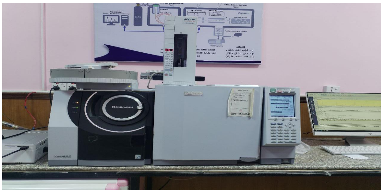
ملحق (12): جهاز GC-MS المستخدم لتحليل عينات الكالس ومعرفة محتواها من المركبات الكيميائية.
