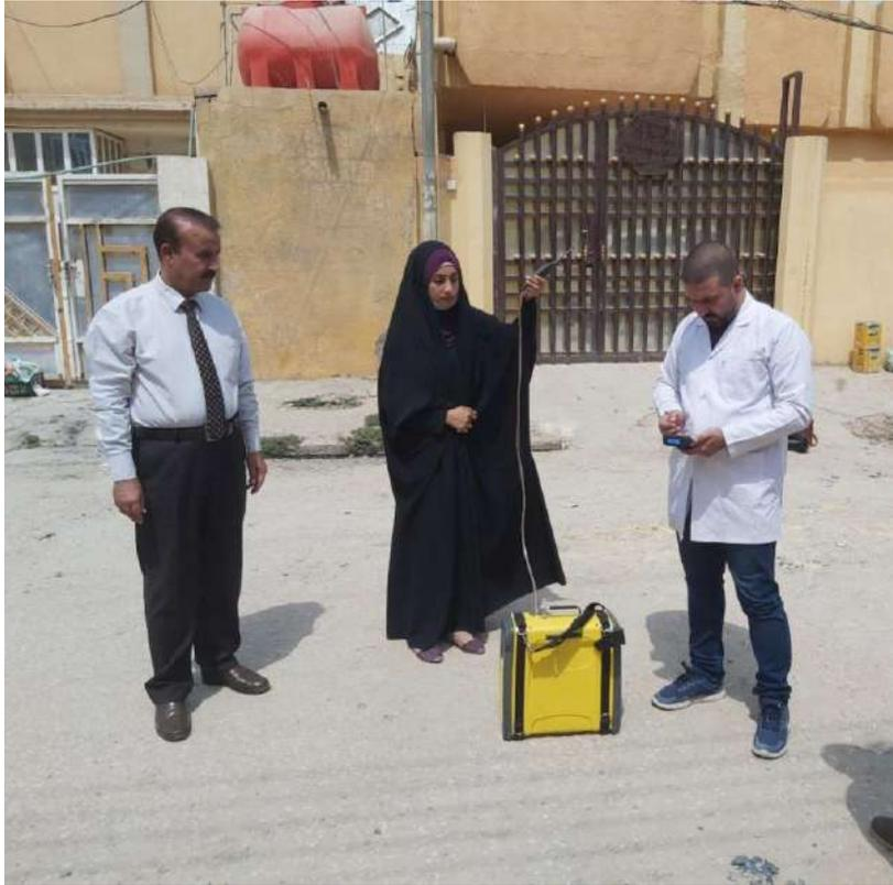
اما قياس العناصر الثقيلة (  $Fe$  ،  $Ni$  ،  $Zn$  ،  $Cr$  ،  $Cu$  ،  $Cd$  ،  $Pb$  ) والتي تم قياسها باستخدام جهاز (Sniffer) ، موضح في صورة (2) ، حيث تم رصدها هي الاخرى في (16) نقطة رصد وهي نفسها التي حددت لقياس تراكيز الغازات ، وللموسمين الشتوي والصيفي.
