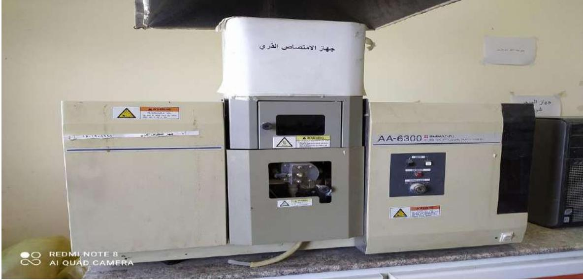
ت. جهاز المطياف اللوني (Color Spectrometry) :- هو جهاز (Germany) المنشأ الذي تم فيه قياس العناصر الثقيلة ، وبحسب الاطوال الموجية لكل عنصر (Ni - 512 ، Cd - 512 ، pb - 607 ، Cr - 552 ، Zn - 575 ، Fe- 565 ، Cu - 400 ، 458 ،) ينظر الى صورة (9) . وقد تمت عملية الهضم باستخدام حامض H<sub>2</sub>O<sub>2</sub> و HNO<sub>3</sub> لحين تكون الرائق.
