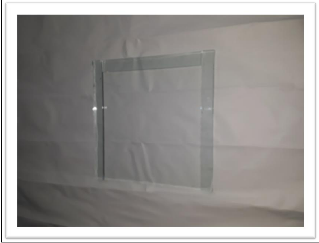
الشكل (3-1) يبين القالب المستخدم في تصنيع العينات
