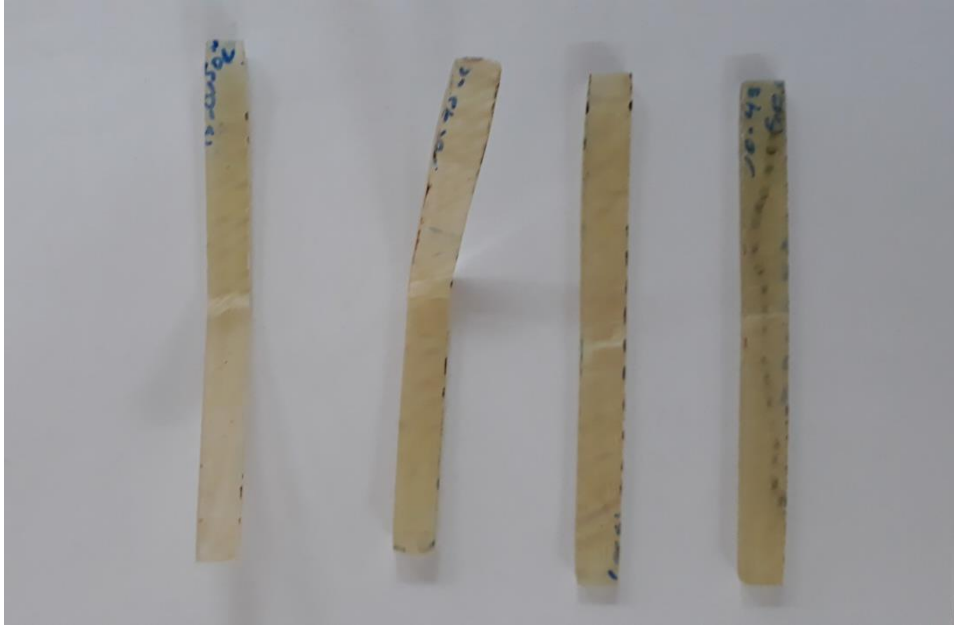
الشكل ( 3-6 ) صورة فوتوغرافية لعينات الانحناء المستعملة بعد الكسر
