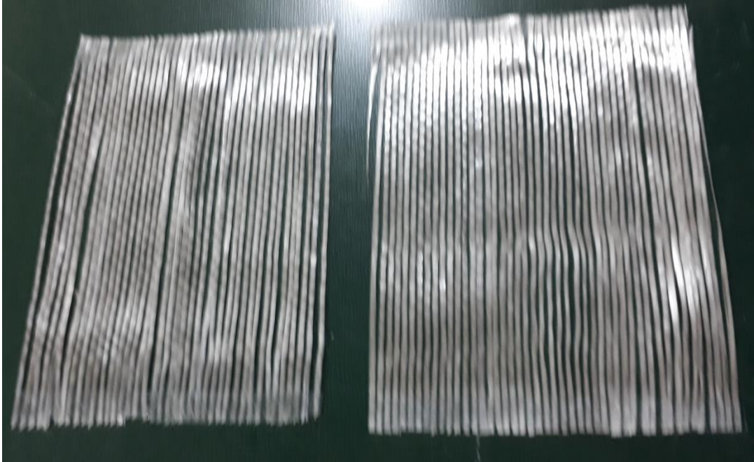
الشكل (2-3) يوضح الياف زجاجية احادية الاتجاه
