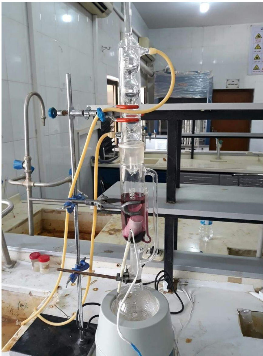
الشكل ( 5 ) لجهاز السكسوليت اثناء العمل
