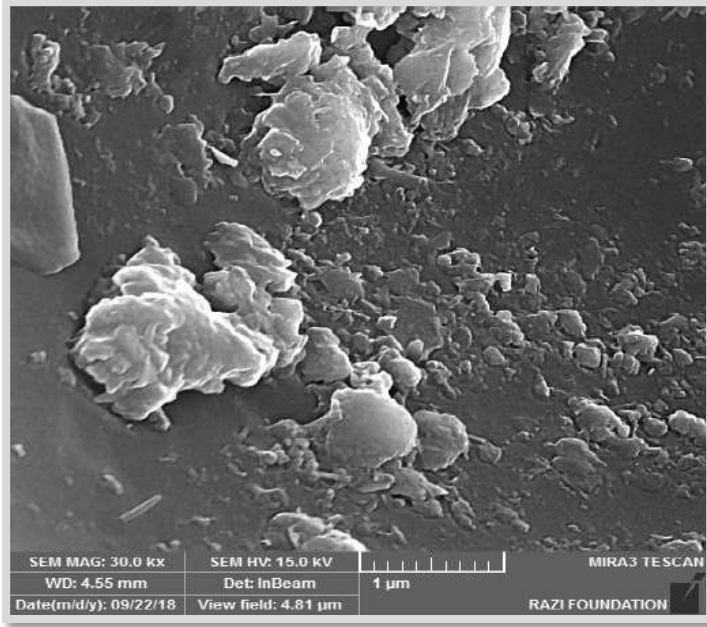
شكل (3- 37) صورة للمجهر الالكتروني الماسح ذي المجال المنبعث (FESEM) للهلام المائي P(AA)
