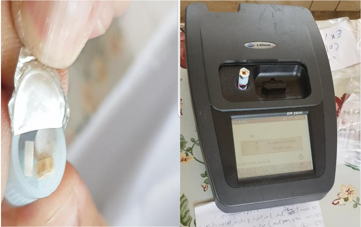
شكل رقم (٥) يوضح جهاز LANGE المستخدم لقياس اختبار BOD
