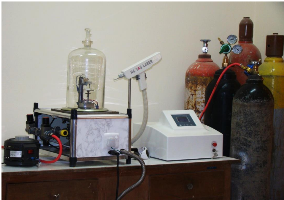
شكل (1-1) يوضح منظومة الليزر النبضي لترسيب أغشية TiO_2 .
