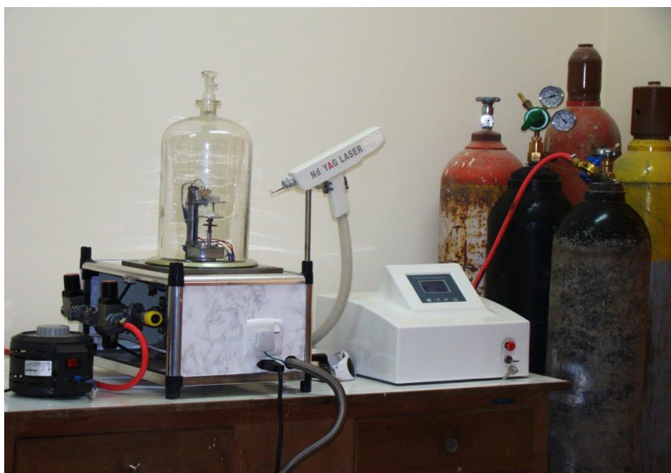
شكل (2-3) يوضح منظومة الليزر النبضي لترسيب أغشية \text{TiO}_2 .
