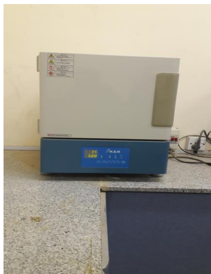
شكل (2-3) يوضح فرن حرق يستخدم في عملية تلدين غشاء ZnO تحت درجة حرارة 400^\circ\text{C} وزمن 30min.
