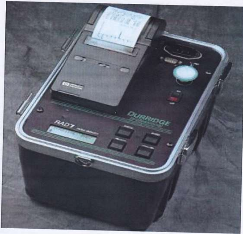
الشكل (1-1) يوضح اساسيات كاشف الرادون [17] RAD7
