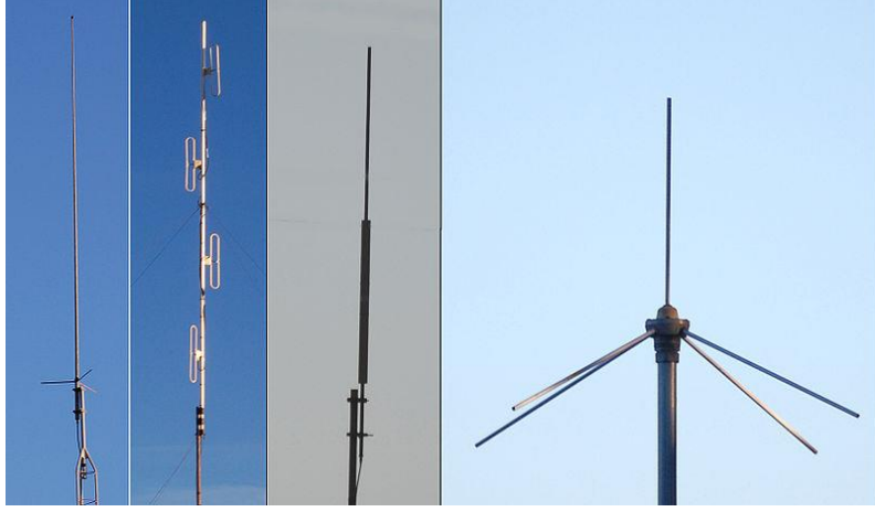
شكل 1 يوضح هوائي في محطة خلوي ذات ترددات من 136 MHz الى 174 MHz
