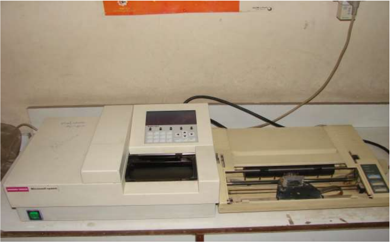
الملحق ( 2 ) جهاز القراءة في اختبار ELISA (Reader, 230 S, Organon Teknika, Belgium)
