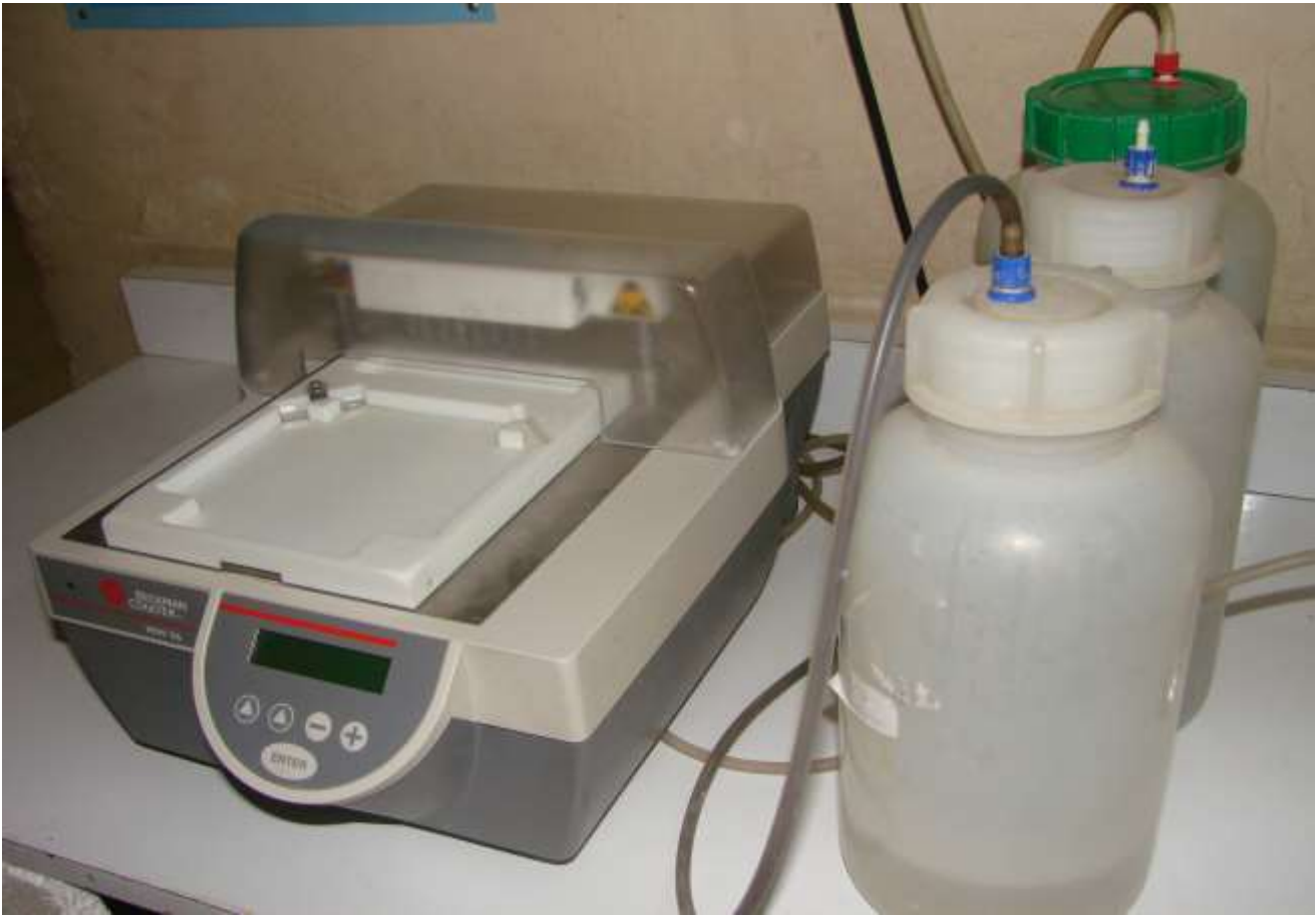
الملحق (6) جهاز الغسل باختبار ELISA (Washer,430, Organon Teknika, Austria)
