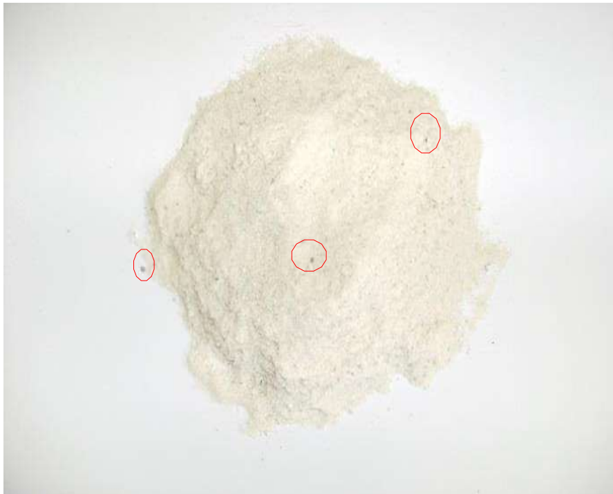
Figure 2 : Poudre de polyuréthane PPU et traces d'impuretés métalliques (cercles rouges)
