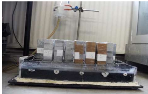
Figure 11. Dispositif expérimental de mesure du coefficient d'absorption capillaire
