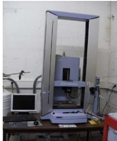
Figure 7 : Dispositif de mesure de la résistance à la flexion
