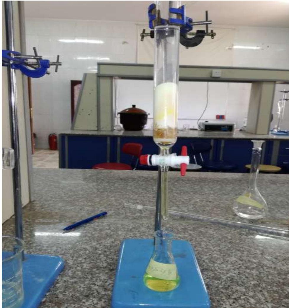
الشكل رقم (11): يمثل صور فوتوغرافيا داخل المختبر والتي توضح مراحل فصل البرمنغنات والدايكرومات بأعمدة الفصل الكروماتوغرافي.
