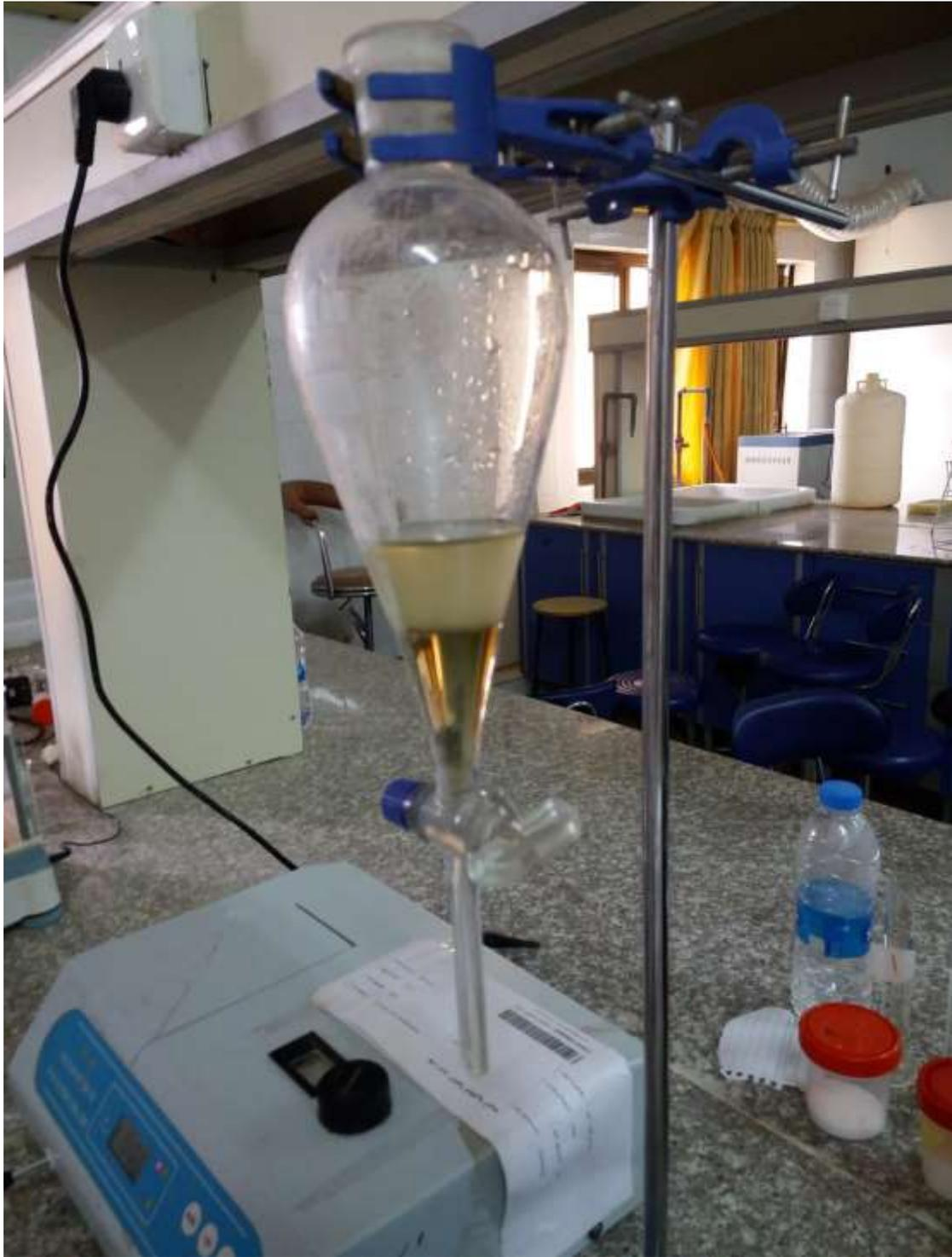
شكل رقم ٥ توضح الاستخلاص المتعدد بالمذيب لعينات الحديد الثلاثي
