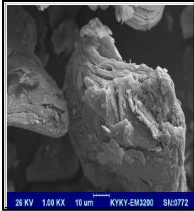
الشكل (3-18): صورة SEM لمسحوق الكرافيت بمقاييس 10\mu\text{m} .
