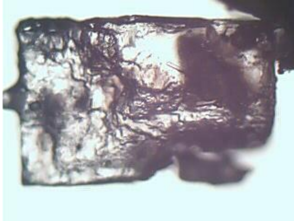
صورة رقم (2) : بلورة ملوثة (احتباس شوائب)
